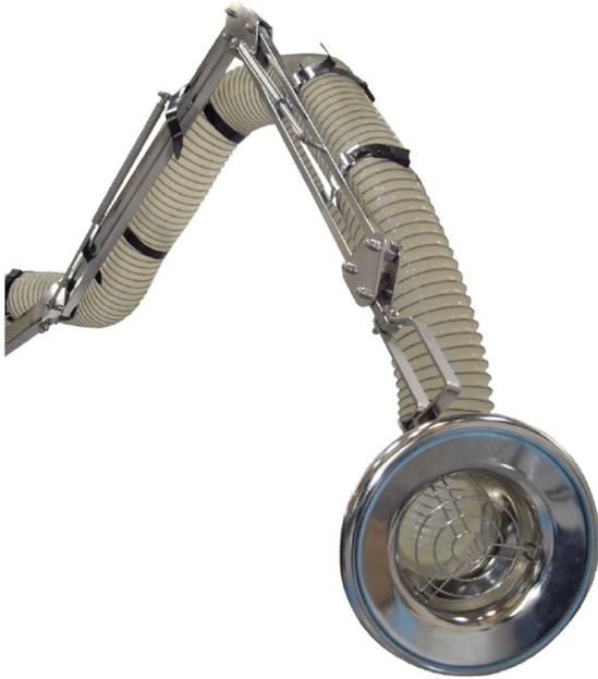
Der NEX S-Arm erfüllt alle Voraussetzungen für den Einsatz in Umgebungen mit explosivem Staub und Gas sowie äußerst strengen Hygienevorschriften. Er ist doppelt geerdet und mit einem anti-statischen Schlauch (Polyuretan) versehen, der den Aufbau statischer Elektrizität und Funkenentstehung verhindert. Das offene Stützarmsystem und eine Haube aus säurebeständigem, poliertem Edelstahl machen ihn wartungsarm und einfach zu reinigen.
